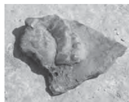
Fig. 129: Scoria di deflusso prodotta dalla fusione del ferro in epoca etrusca, da Populonia.
