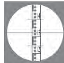
Fig. 97 (sotto): La stadia vista guardando nel livello ottico: la misura letta è 131,1 cm.
