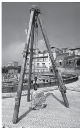
Fig. 143: Vitruvio dedica il X libro del De Architettura alla meccanica e descrive così il rechamus: "Si prendono pezzi di legno di misura adeguata alla dimensione dei pesi da sollevare. Questi vengono messi per ritto, legati in cima e divaricati in basso. Vengono tenuti in questa posizione per mezzo di tiranti fissati alla sommità e disposti intorno a essi; al vertice viene appeso un bozzello (trochlea)". Il modello ricostruttivo della macchina per il sollevamento mostra la capra (rechamus) a cui erano appesi la carrucola (trochlea), il verricello (sucula) e i paranchi (machina tractoria).
