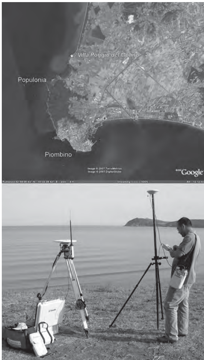
Fig. 221: L'acquisizione di dati spaziali avviene tramite telerilevamento (immagini satellitari), GPS (Global Positioning System), ossia un sistema di posizionamento su base satellitare, oppure mediante i tradizionali metodi di rilievo topografico (con teodolite e barometro) o altre fonti di dati (cartografia).
