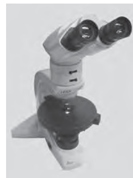
Fig. 213: Il microscopio polarizzatore, a differenza del microscopio ottico, presenta un filtro, posto tra sorgente luminosa e tavolino portaoggetti, che converte la luce da "parallela" a "polarizzata". Il filtro è fondamentale per evitare che il raggio luminoso colpisca il campione in moltissime direzioni differenti, rendendo l'analisi non oggettiva e la visione non chiara.
