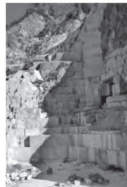
Fig. 141: Coltivazione a gradini in una moderna cava di marmo di Carrara.
