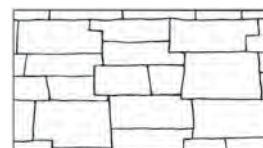
Fig. 145: Parte del paramento murario della crepidine della tomba dei Carri (necropoli di San Cerbone, Parco Archeologico di Baratti e Populonia): i blocchi in calcarenite sono caratterizzati dalla sagomatura con “dentelli a incastro”.
