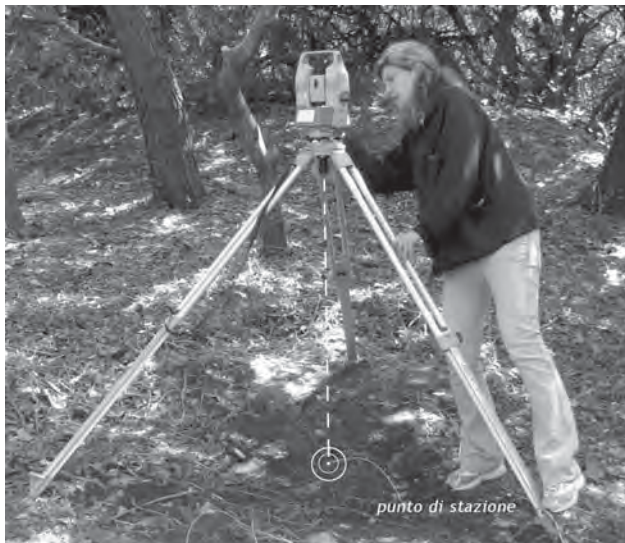
Fig. 100: La stazione totale: centratura dello strumento.
