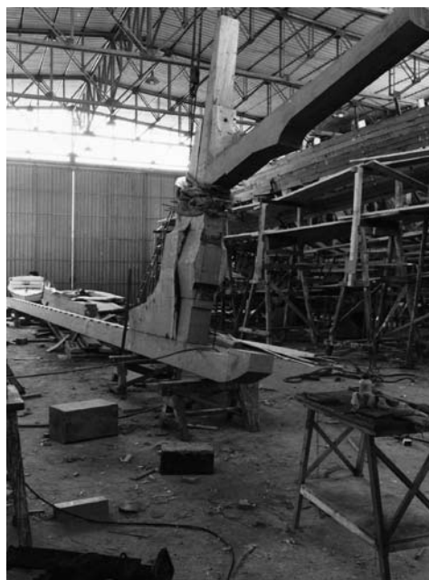
10-11. Dritto di poppa e dritto di prua di una nave scuola per la pesca costruita al cantiere Beconcini per l'Algeria 10-11. Stempost and bow-post of a fishing boat (training ship) built at Cantiere Beconcini for exportation to Algeria
