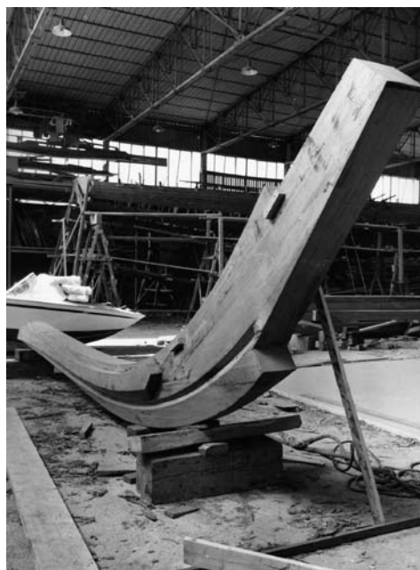
10-11. Dritto di poppa e dritto di prua di una nave scuola per la pesca costruita al cantiere Beconcini per l'Algeria 10-11. Stempost and bow-post of a fishing boat (training ship) built at Cantiere Beconcini for exportation to Algeria
