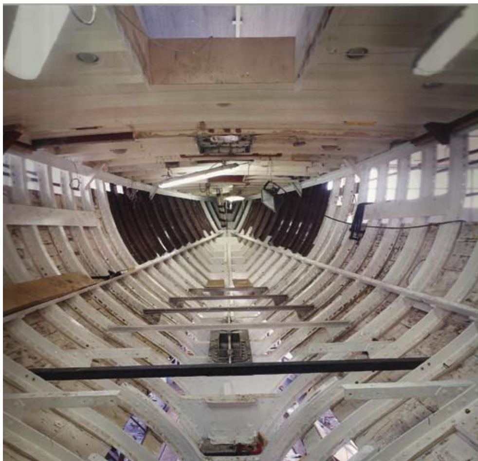
12. L'ossatura dell'imbarcazione d'epoca a vela Latifa in restauro al cantiere Beconcini (1989) 12. The ribs of the classic sailing yacht Latifa during restoration at Cantiere Beconcini (1989)
