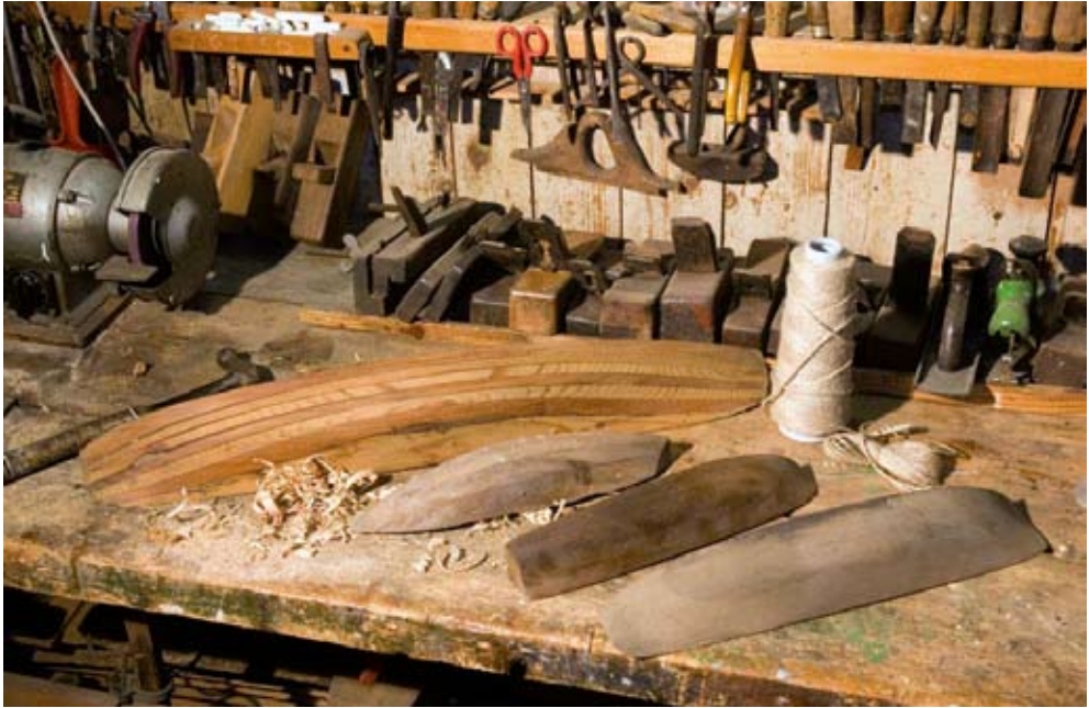
37. Mezzi scafi modellati dai maestri d'ascia nella prospettiva di realizzare le imbarcazioni a grandezza naturale 37. Half hulls built by master shipwrights prior to building the full-sized vessels
